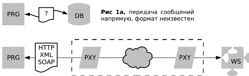
Рис 1б , передача сообщений через веб-сервисы; распространение может проходить в сетях без прямого разрешения конечных точек благодаря протоколу HTTP; структура данных задаётся при помощи XML, а информация о вызове – протоколом SOAP.
