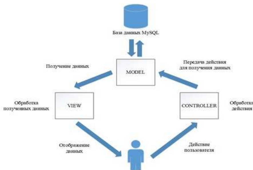
Рис. 1. Схема MVC (Model-View-Controller)
